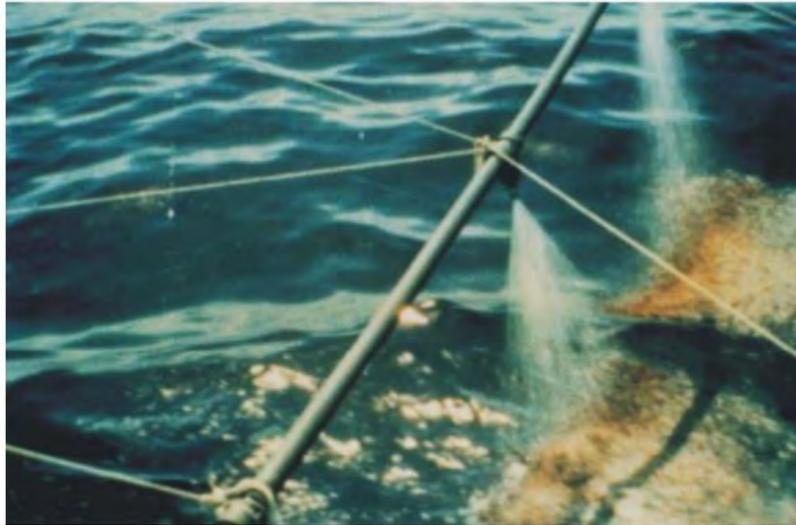
*Figura 6. Rociado del dispersante desde una embarcación (ARPEL, 2007)*
