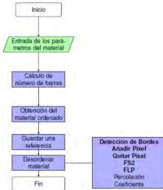
Figura 3.3: Diagrama de flujo general del proceso de desordenamiento
