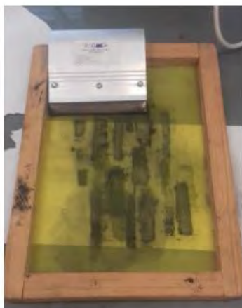
Figura 3.3 Racero y tabla para metodo serigrafia.
