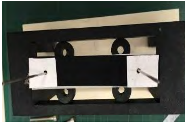
Figura 3.4 Sellos de polímero GORE -TEX® en celda de combustible.
