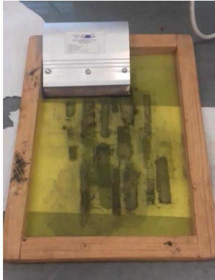
Figura 9. Manigueta y shablon utilizados para serigrafía.
