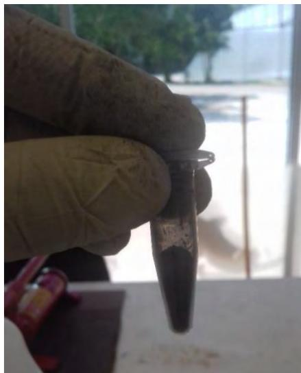
Figura 8. Tinta catalítica después de agitación ultrasónica.
