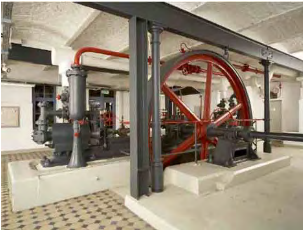
Figura 1.9. Primer refrigerador comercial del mundo, la máquina de amoníaco frío, para la cerveza. Fuente: Pérez (2013).
