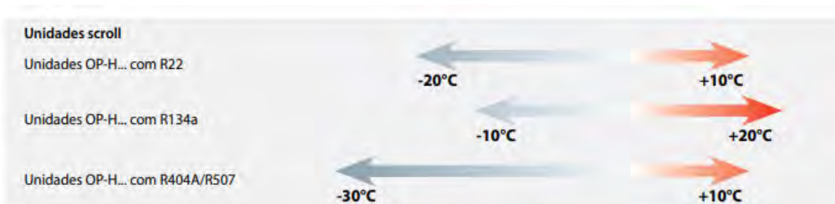
Figura 4.15. Límites de aplicación (Temperatura de evaporación °C). Fuente: Catalogo de Unidades Condensadora Optyma. Alta eficiencia frigorífica y energética. Danfoss.
