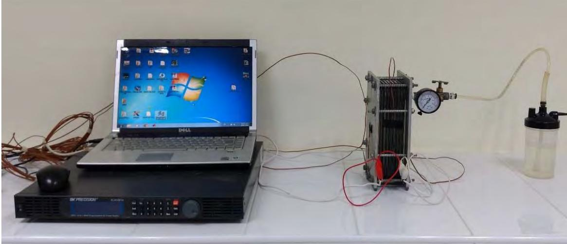
*Figura. 3.6 Arreglo para pruebas con fuente de alimentación y electrolizador alcalino.*
