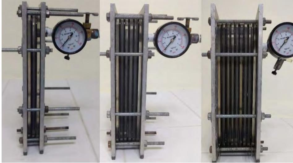
*Figura. 3.5 Electroizador alcalino en etapas de escalamiento, 1, 4 y 7 celdas.*
