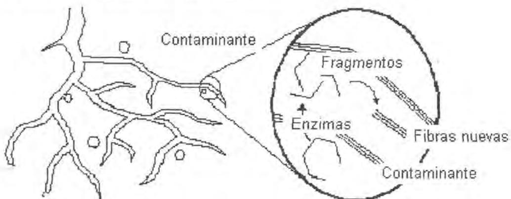
**Figura 5** Destrucción de contaminantes orgánicos por fitotransformación.<sup>20</sup>
