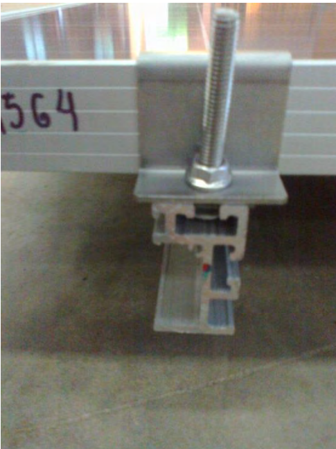
Figura 57: Fotografía de un sujetador y perfil de carril longitudinal.
