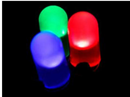
Figura 2.2.- Imagen de un Led (diodo emisor de luz). color rojo, verde y azul.
