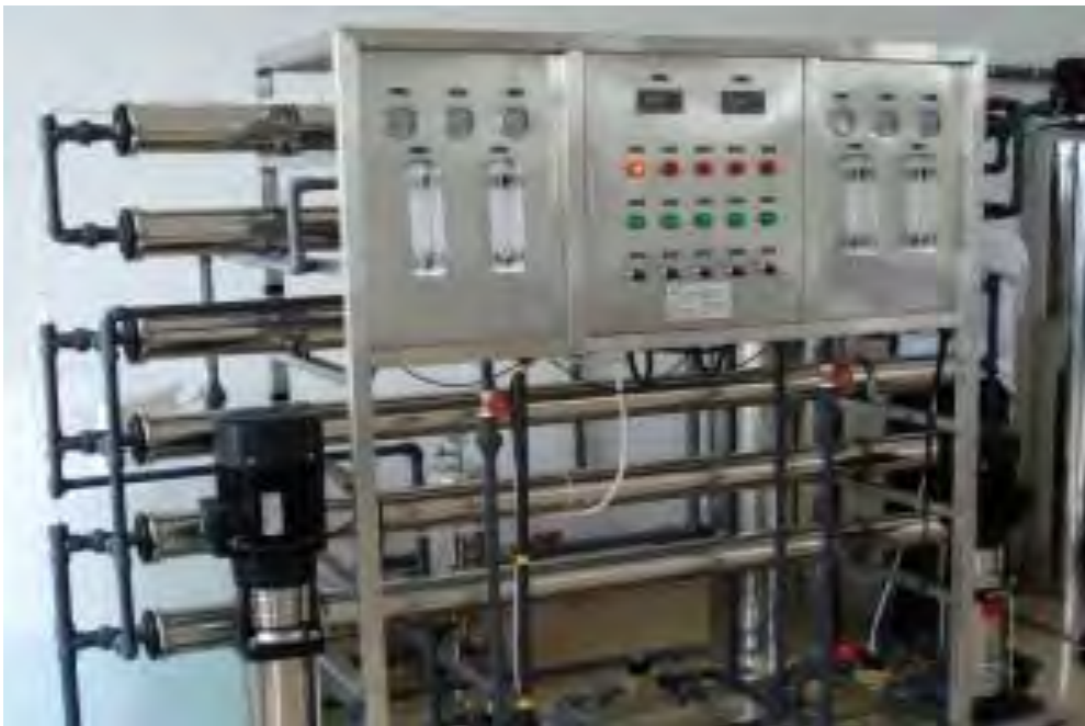
Figura No. 5 Equipo de Ósmosis inversa
