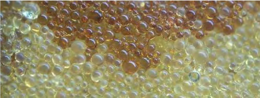
Figura No.6 Típica resina de intercambio iónico
