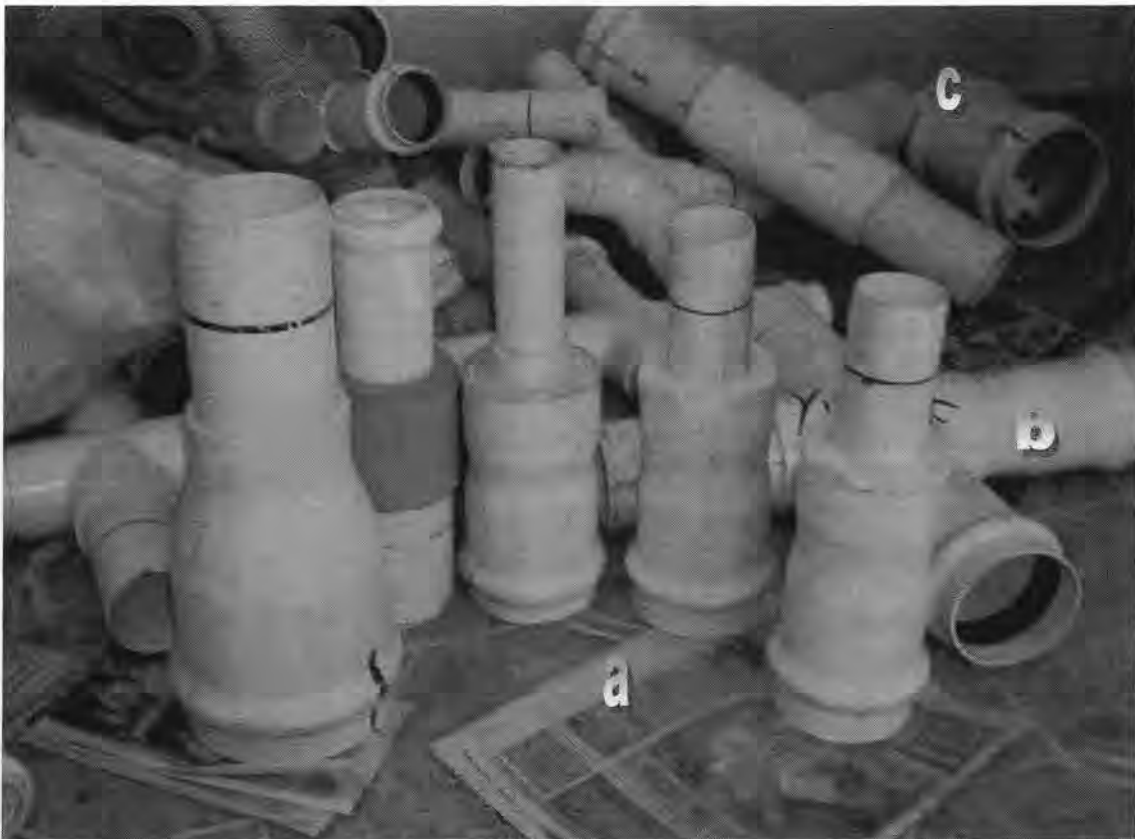
Figura 9. Piezas especiales en sistema anger: a) Reducciones de diferentes diámetros, b) Cruz de 4", c) Te de 3".
