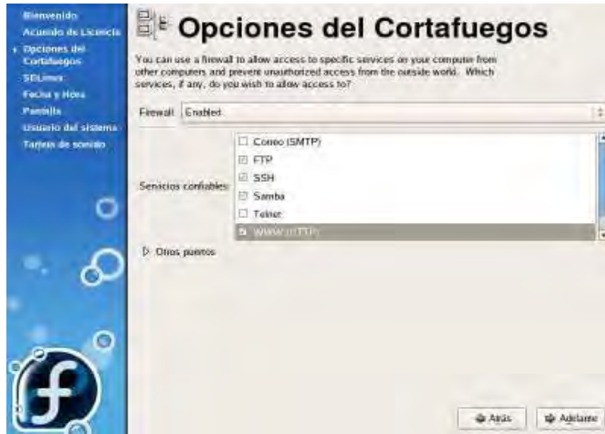
Figura 21: Pantalla de Configuración del Firewall.
