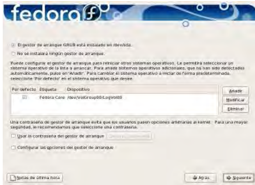
Figura 9: Pantalla de Configuración del Gestor de Arranque GRUB. Posteriormente clic en el botón "Siguiente".
