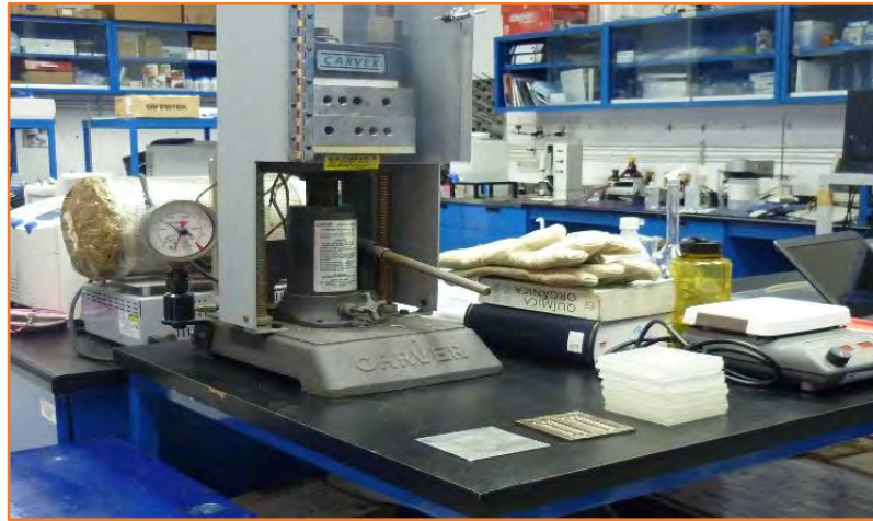
Fig. 3.7 Fotografía de la prensa marca CARVER® de platos bipolares.
