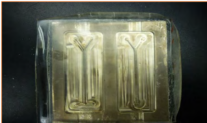
Fig. 3. 8 Fotografía del molde y sustrato después de comprimirlo y retirarle la placa de acero.
