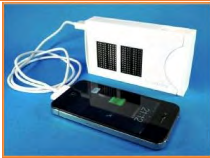
Fig. 2.4 Prototipo de Hydrogen fed micro-fuel cell de la empresa Aquafairy AF-M3000 (Aquafairy Corporation, 2011).
