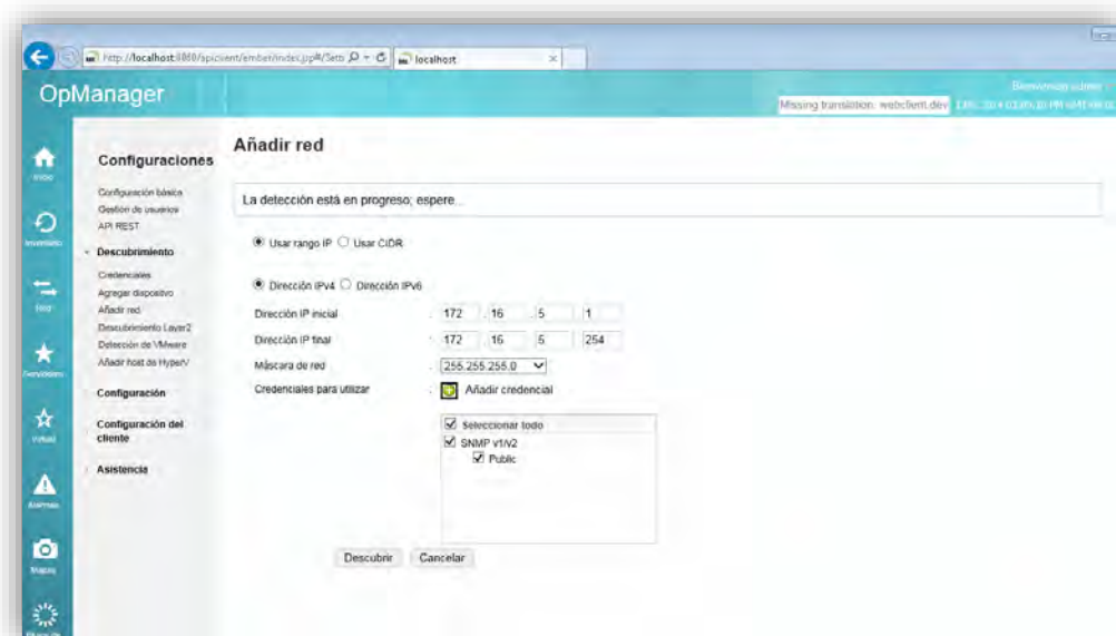
Figura 64 OpManager. Adición de red
