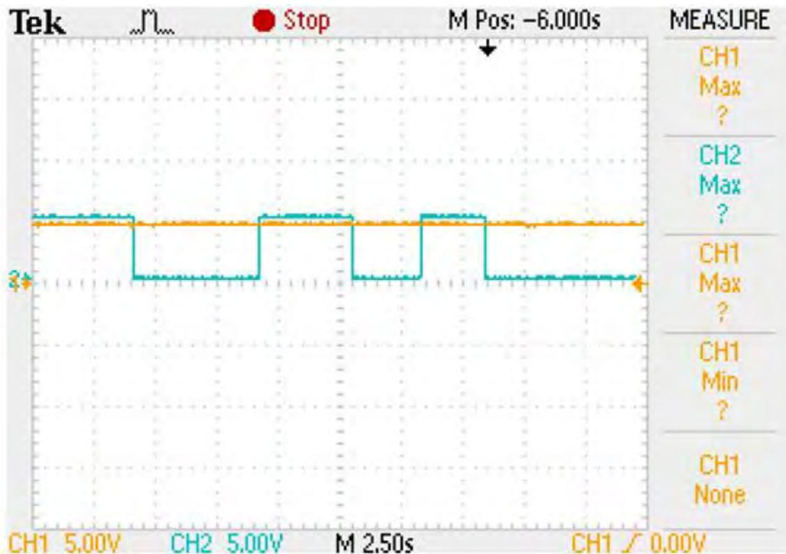
**Ilustración 56. Señal de XBee y BS2 emisores mediante Radio frecuencia. Elaboración Propia. Enero 2015.**
