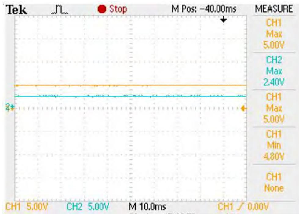
Ilustración 57. Señal de XBee y BS2 receptores mediante Radio frecuencia.Elaboración Propia. Enero 2015.
