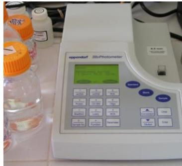
**Figura 2.11** Espectrofotómetro para cuantificar la cantidad y pureza de DNA.
