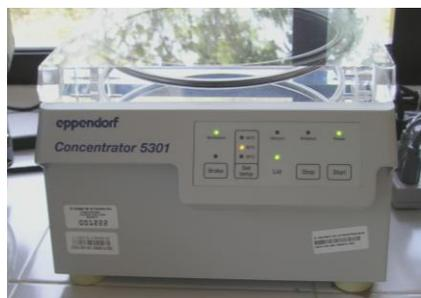
**Figura 2.10** Concentrador par el secado del DNA extraído.
