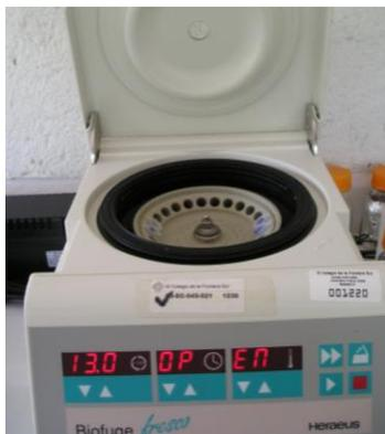
**Figura 2.9** Centrifugación de las muestras a 13 000 rpm.
