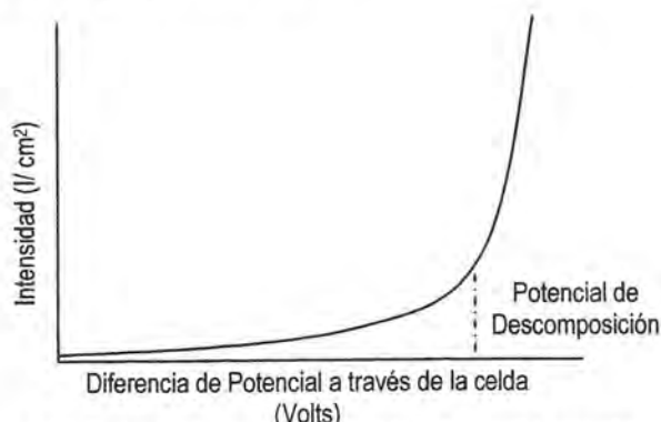
Figura 3.17.- Ejemplo de una curva potenciodinámica del ensamble
