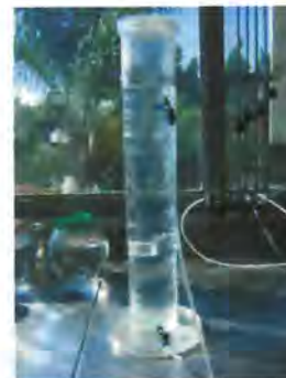
Figura 2.9.- Tanque de abastecimiento del agua y almacenamiento del gas.
