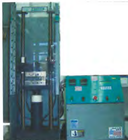
Figura 3.12.- Prensa Hidráulica (Carver ® modelo 3889-1D0A00)
