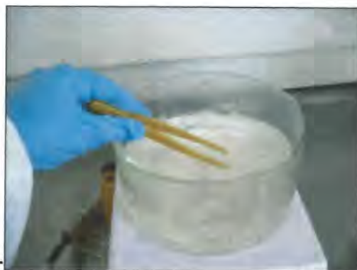
Figura 3.1.- Baño químico de la membrana sólida polimérica
