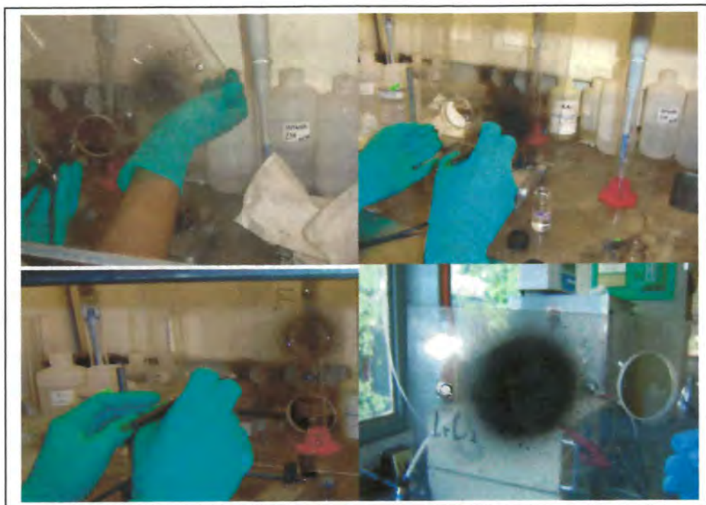
Figura 3.9.- Aplicación de la tinta catalítica sobre la membrana mediante la técnica de spray.
