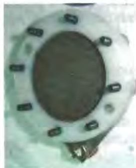
Figura 2.7.- Electrolizador tipo ESP sin una de las placas de soporte para la visualización de algunos de sus componentes.
