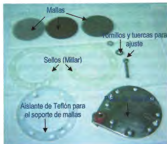
Figura 2.8.- Componentes del Electrolizador
