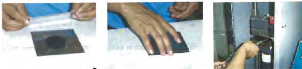
Figura 3.11.- (a).-Puesta del ensamble en las placas, (b) y (c).- Ensamble listo para introducir a la prensa
