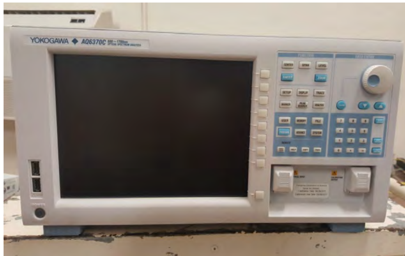
Figura 18. Analizador de espectros ópticos (OSA) usado para la caracterización de SRS
