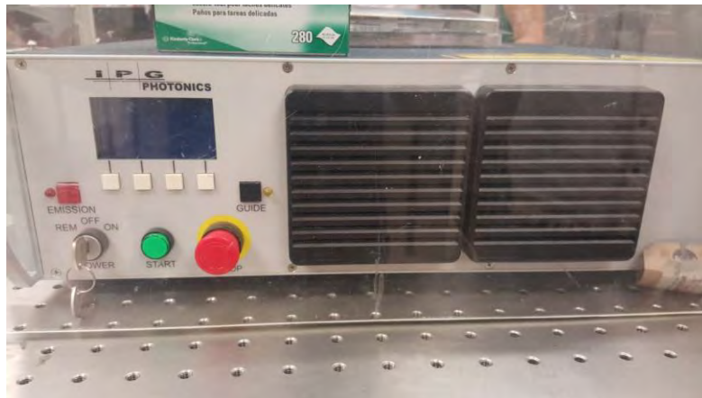
Figura 17. Láser a 10W usado para SRS
