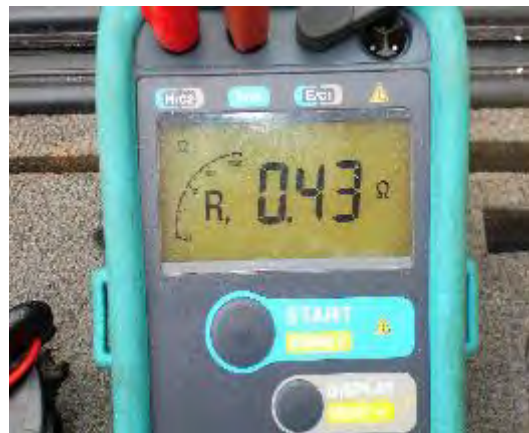
Figura 12. Valor de la resistencia de la tierra física.
