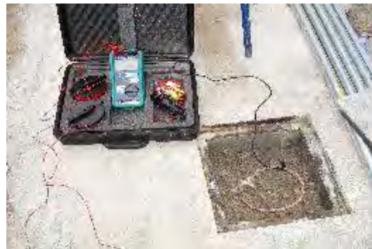
Figura 10. Pruebas de medición de la tierra física.
