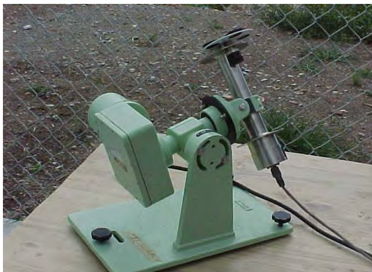
Figura 4.2. Fotografía de un pirheliómetro montado en un sistema electromecánico de seguimiento. [36]
