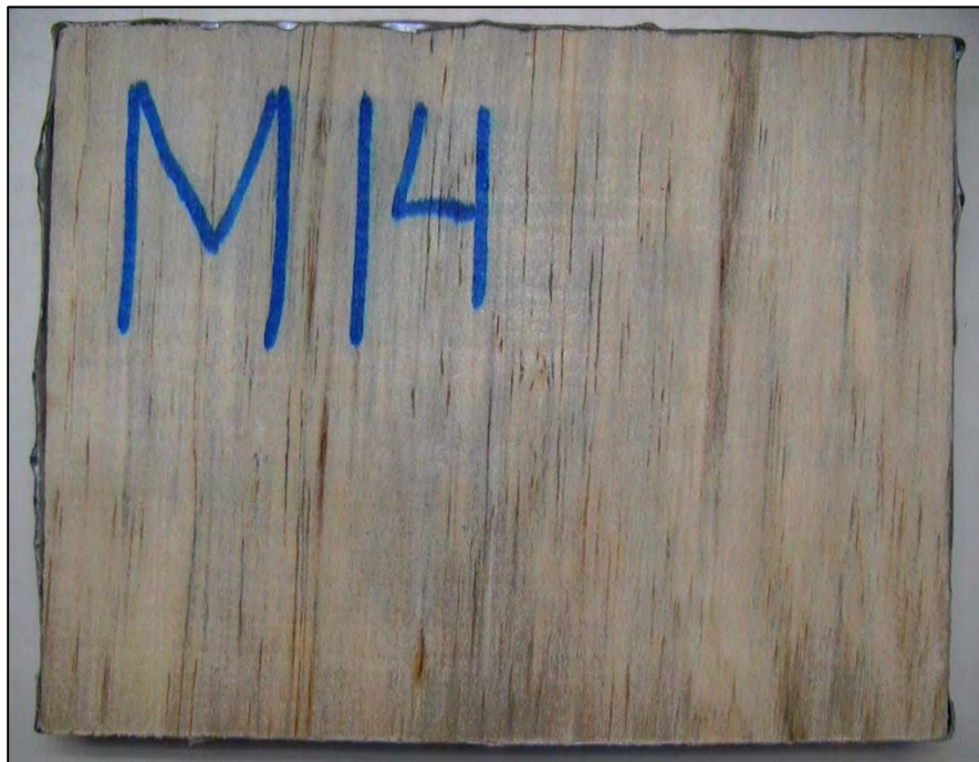
Anexo 8. Foto de la muestra M14, flujo perpendicular, temperatura 60°C, velocidad 2.5 m/s después del secado.
