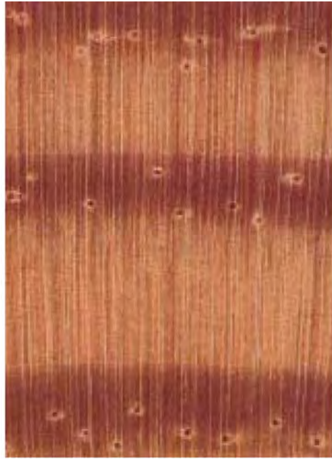
Figura 1.7. Pino amarillo del Sur ( Pinus spp. ) estructura de corte transversal 20x [14].
