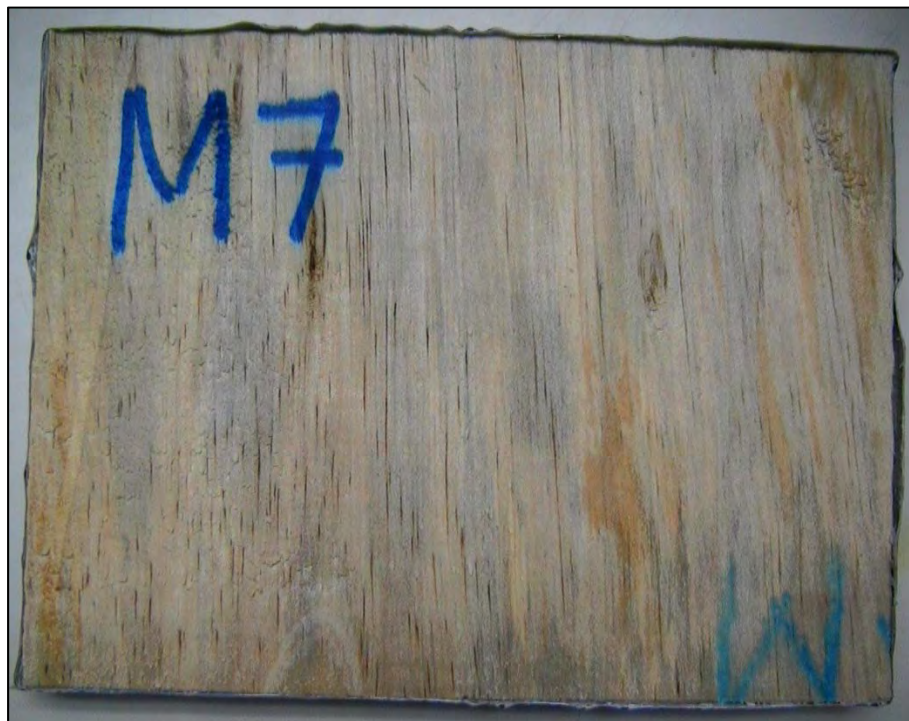
Anexo 4. Foto de la muestra M7, flujo perpendicular, temperatura 50°C, velocidad 2.5 m/s después del secado.
