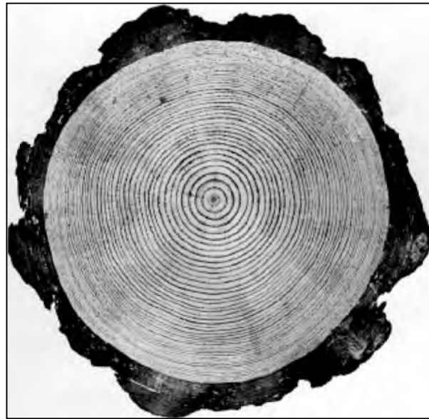
Figura 1.4. Corte transversal de un tronco de pino de ponderosa mostrando sus anillos de crecimiento. Las cintas de color más clara es la madera temprana y las cintas oscuras es la madera tardía. Un anillo anual (crecimiento) está formado de una zona de madera temprana interior y una zona de madera tardía externa [6].
