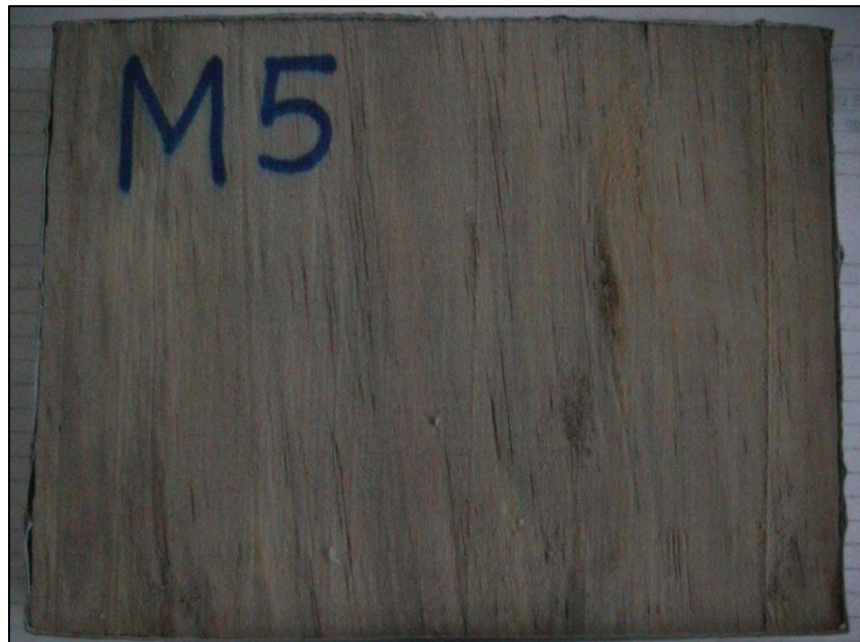
Anexo 2. Foto de la muestra M5, flujo perpendicular, temperatura 50°C, velocidad 1.8 m/s después del secado.
