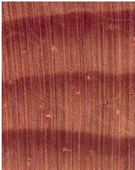
Figura 1.8 Pino Rojo ( P.resinosa ) estructura de corte transversal 20x [8].
