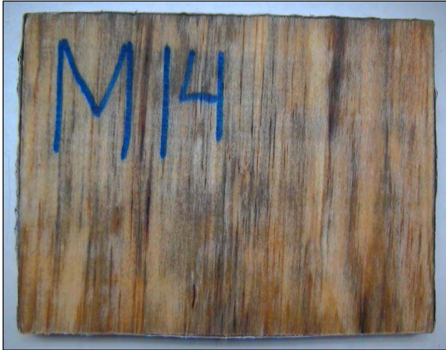
Anexo 7. Foto de la muestra M14, flujo perpendicular, temperatura 60°C, velocidad 2.5 m/s antes del secado.
