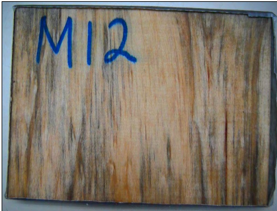
Anexo 5. Foto de la muestra M12, flujo perpendicular, temperatura 60°C, velocidad 1.8 m/s antes del secado.
