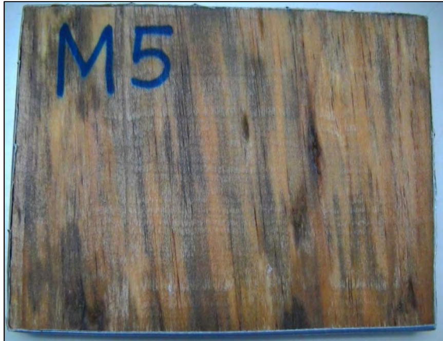
Anexo 1. Foto de la muestra M5, flujo perpendicular, temperatura 50°C, velocidad 1.8 m/s antes del secado.
