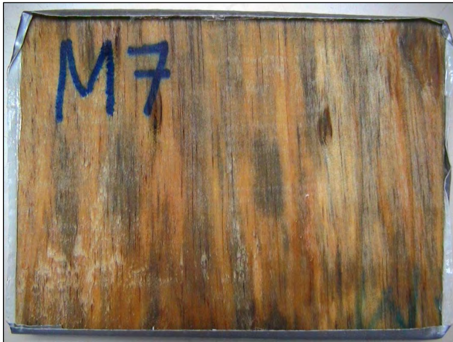
Anexo 3. Foto de la muestra M7, flujo perpendicular, temperatura 50°C, velocidad 2.5 m/s antes del secado.
