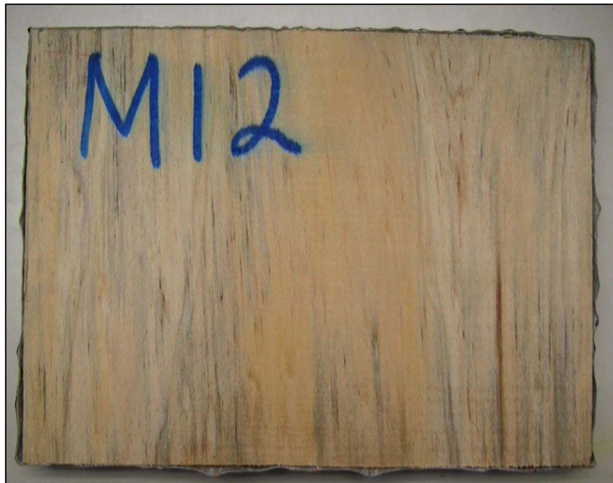
Anexo 6. Foto de la muestra M12, flujo perpendicular, temperatura 60°C, velocidad 1.8 m/s después del secado.
